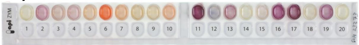
Abbildung 2: Apizym-Teststreifen mit Keim DSM 23273.
