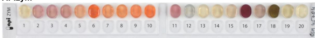
Abbildung 2: Apizym-Teststreifen mit Keim DSM.
