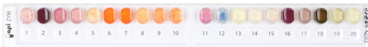
Abbildung 2: Apizym-Teststreifen mit Keim DSM 46717.
