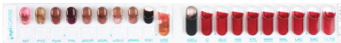
Abbildung 1: Apicoryne-Teststreifen mit Keim DSM 46744.
